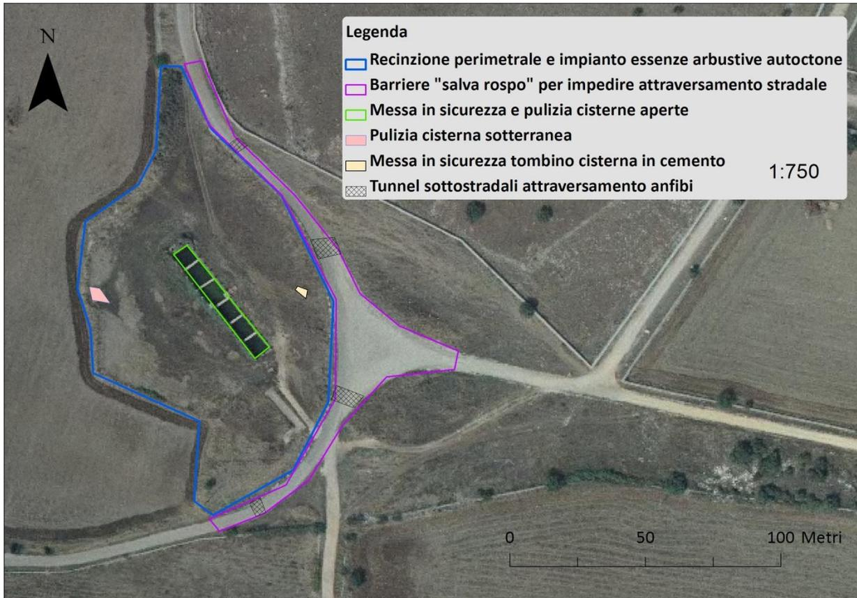
Figura 10 Esempio d'interventi di riqualificazione/ripristino.
