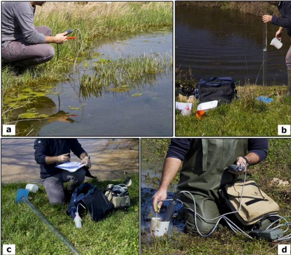
**Figura 6 – rilevamento delle variabili ambientali. a) e d) rilevamento variabili con sonda multiparametrica; b) valutazione della torbidità dell'acqua. c) annotazione dei valori su apposita scheda**
