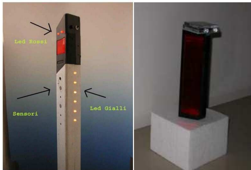
Figura 4-11 - Esempi di dissuasori ottici (destra) e misto a led e ultrasuoni (a sinistra).
